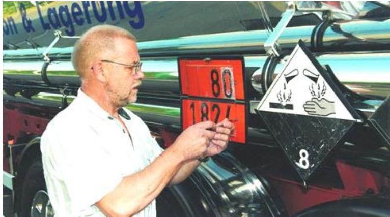
Resim 1.23: İkaz levhalarının takılması
